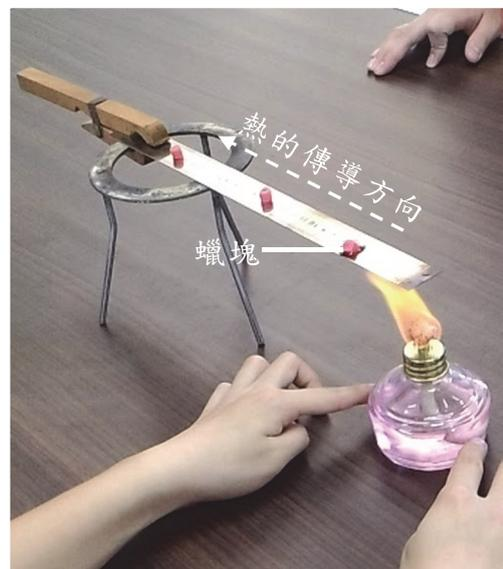
► 熱傳導實驗：愈靠近火源的蠟塊，愈先受熱融化
