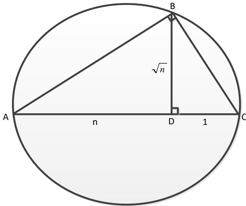
令 $\overline{AD} = n$ ， $\overline{DC} = 1$ ，畫一 $\overline{AC}$ 為直徑的圓，則 $\triangle ABC$ 為一直角三角形，因 $\angle ABC$ 一定是直角，此時 $\overline{BD}^2 = \overline{AD} \times \overline{DC} = n$
